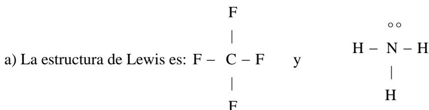
b) La molécula de tetrafluoruro de carbono es una molécula del tipo  $\text{AB}_4$ , (cuatro pares de electrones compartidos y 0 pares de electrones sin compartir), tendrá forma tetraédrica. La molécula de amoníaco es una molécula del tipo  $\text{AB}_3\text{E}$ , (tres pares de electrones enlazantes y uno no enlazante), tendrá forma de pirámide triangular.
