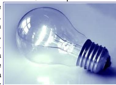
En este fenómeno de incandescencia se basa el funcionamiento de las bombillas convencionales, llamadas por ello, lámparas de incandescencia. En dichas lámparas, el filamento de wolframio (un metal) alcanza unas temperaturas de 2000-3000°C al pasar por el la corriente. Para evitar que se queme, el filamento se encierra en una ampolla de vidrio en la que se elimina el oxígeno (haciendo vacío o conteniendo una mezcla de argón y nitrógeno).
