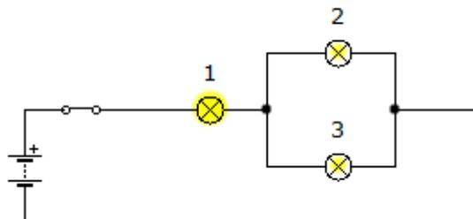
Estos circuitos poseen las características de los dos circuitos, por lo que se tiene que resolver poco a poco por partes. En primer lugar se resuelven los elementos que están en paralelo (bombillas 2 y 3), y luego los que están en serie.
