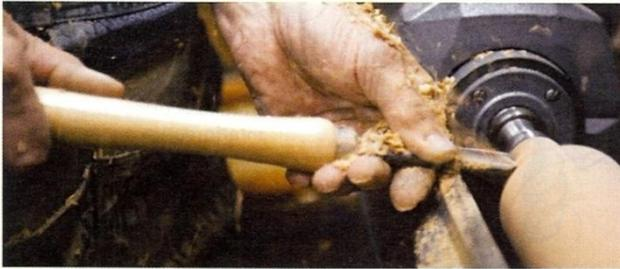
**Torno.** Esta máquina hace girar la pieza de madera, para poder trabajarla utilizando una cuchilla que se puede cambiar de posición. También sirve para hacer cuencos vaciando el interior.
