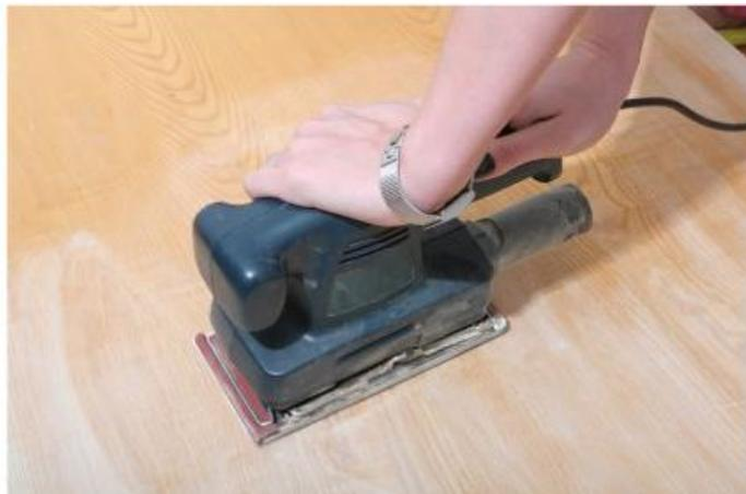
*Lijando la superficie de un tablero con una lijadora orbital.*
