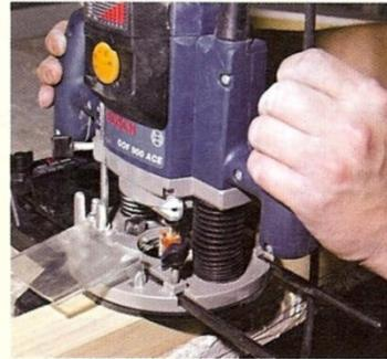
**Fresadora.** Esta máquina permite hacer molduras y determinados ensamblajes. Dispone de una cuchilla especial, llamada **fresa**, que puede moldear formas variadas.
